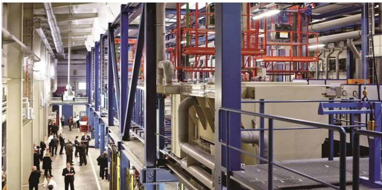
Europa's grootste installatie voor het elektrolytisch vernikkelen van series en kleine onderdelen is te vinden in de vestiging van Aalberts surface technologies in Weiterstadt.
