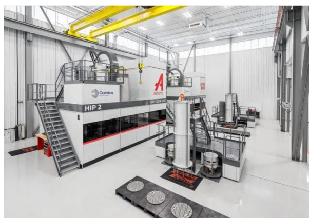
Rechts: de pers verbetert de materiaaleigenschappen van bedrijfskritische onderdelen in onder meer de luchtvaartindustrie.
